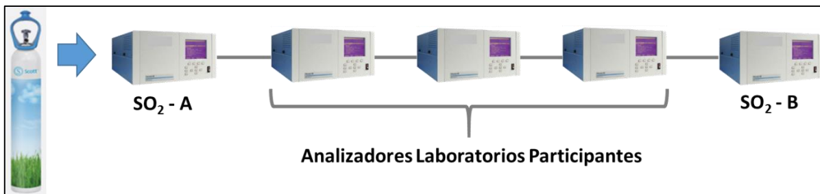
Ilustración 7-2. Diagrama de instalación de analizadores de Red MACAM.
