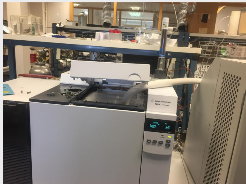
GC-MSD y línea de transferencia multicanister NILU
